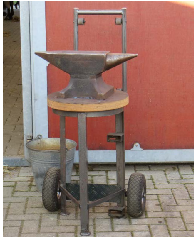
Abb. 3-1 Verfahrbarer Amboss auf lärmindernder Holzplatte
