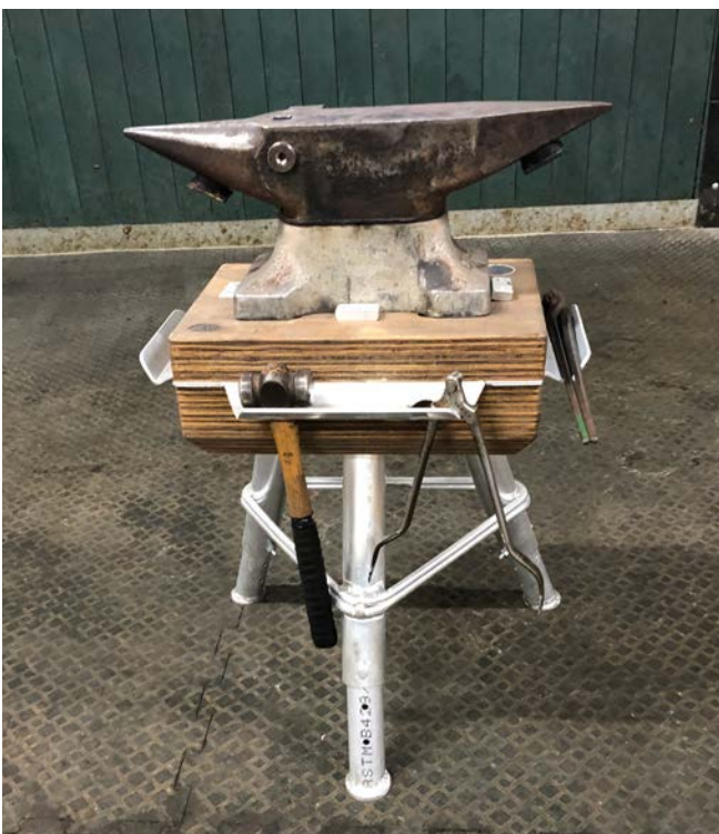
Abb. 3-2 Amboss mit Magneten zur Geräuschminderung
