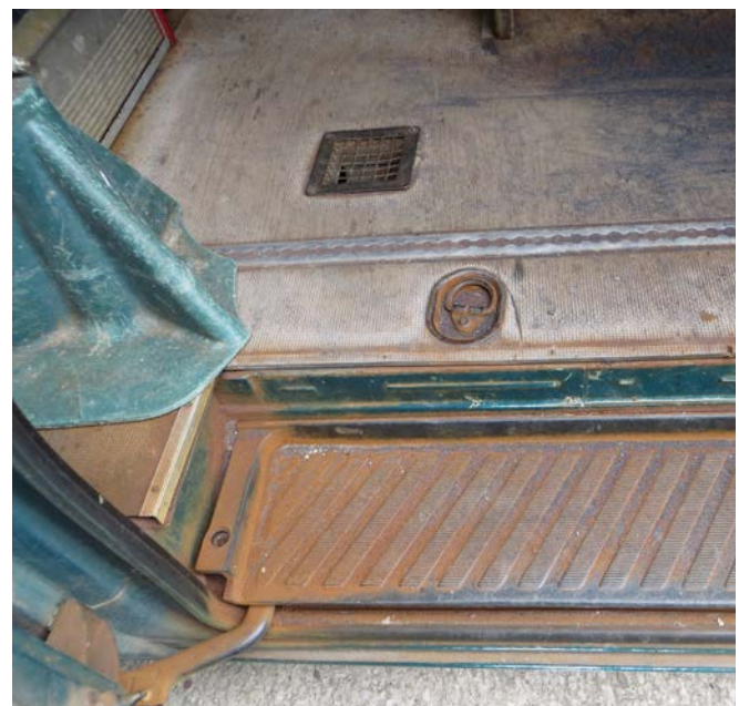
Abb. 9-1 Belüftungsöffnung im Fahrzeugboden
